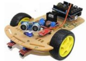
ARDUINO est une carte programmable équipée d'un microcontrôleur et d'un environnement de programmation, qui permet de traiter les informations acquises par les capteurs et les détecteurs.
